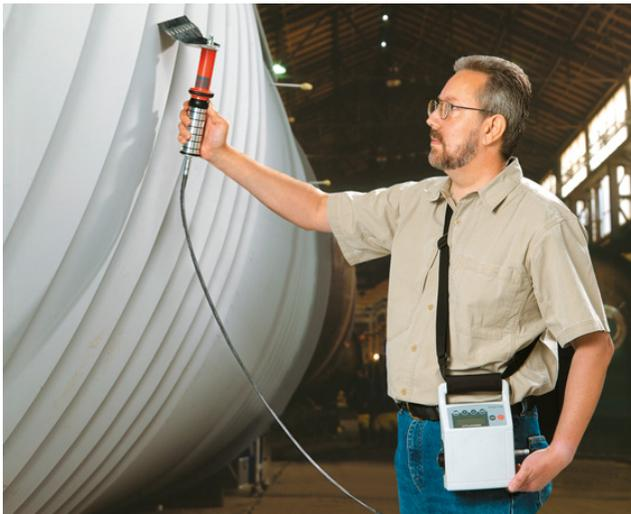
Détection fiable des porosités, soufflures et piqûres de tous revêtements isolants sur bases métalliques :
